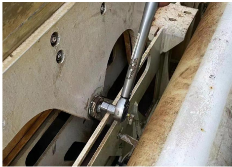
图 11 力矩扳手未能套入螺帽 (限位块未完全卡入导向槽时)
